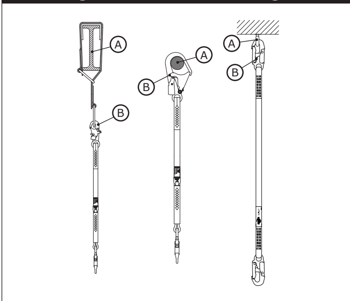
Figure 7 - Connexion à l'ancrage
