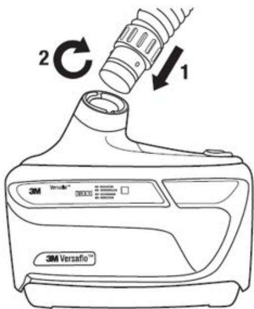
Figure 7: Extracción del tubo de respiración
